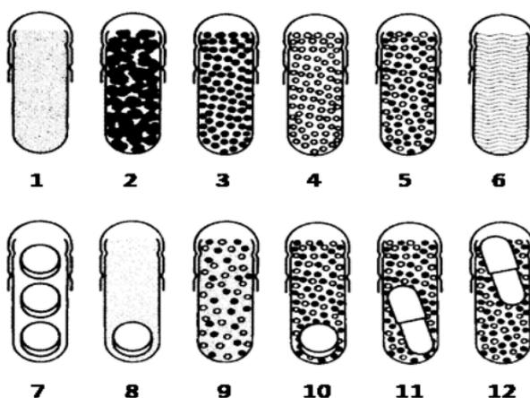
Рисунок 1.6. Комбинация наполнителей для твердых капсул
